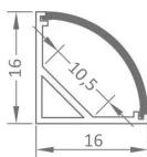
**Profilé alu d'angle pour bande LED.** Diffuseur arrondi, type  $\frac{1}{4}$  de rond. 16 mm x 16 mm - Compatible avec rubans de 10 mm de largeur max.
