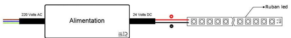
**Branchements d'un ruban LED monocolore avec variation d'intensité lumineuse par télécommande radio :**
