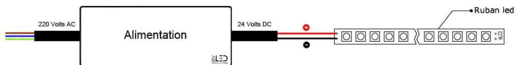
**Branchements d'un ruban LED monocolore avec variation d'intensité lumineuse par télécommande radio :**
