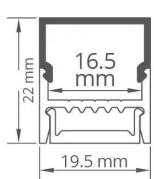
**Profilé en applique pour ruban LED.** Aluminium avec finition anodisée. 22 mm x 19,5 mm - Intégration d'un ruban LED ne dépassant pas 16 mm de large.
