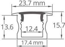
**Profilé à encastrer pour bandeau LED.** Aluminium, finition anodisée. 23,7 mm x 15,7 mm - Adapté aux rubans de 12 mm de largeur maximum.
