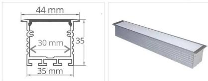
**Profilé encastrable pour ruban LED Large** Il peut accueillir deux rubans. 44 mm x 35 mm – Compatible avec les rubans larges de 31 mm max. ou 2 rubans de 15 mm de large max.
