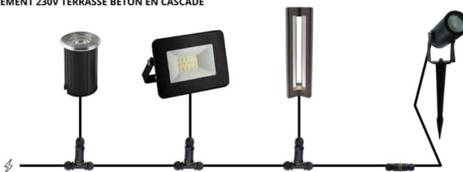
BRANCHEMENT 230V TERRASSE BÉTON EN CASCADE
