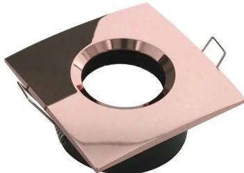
VERSION COUPE-FEU (RECOUVRABLE) : Perçage: 72 mm | Profondeur: 117 mm | Compatible avec toutes les collerettes Split.
