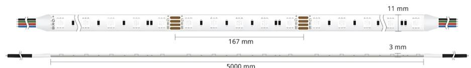
**Ruban LED RGB 5 mètres.** Contrôlable à distance avec un [contrôleur et une télécommande](#) (vendus séparément). Étanche aux projections d'eau ponctuelles IP65 – SMD 5050 – 7,2W/m - 60 LED/m - 24V.
