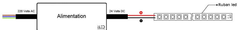
**Branchements d'un ruban LED monocolore avec variation d'intensité lumineuse par télécommande radio :**
