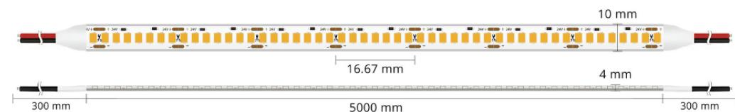
**Ruban LED 13W/m à haute densité de LEDs : 420 LEDs/m - 5 mètres - IP68 (utilisation en extérieur) - 120 lm/W - 24V.** Équipé d'un puissant adhésif (3M©) à son dos.
