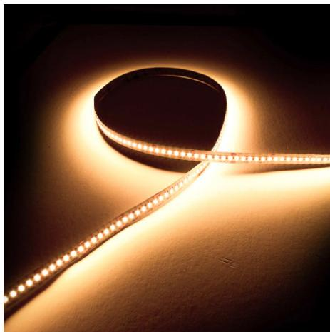
**Ruban LED 20 W/m très haute efficacité : 160 lm/W - 5 mètres - IP20 : Installation en intérieur - 160 LED/m - 24V - Équipé d'un puissant adhésif (3M©) à son dos**
