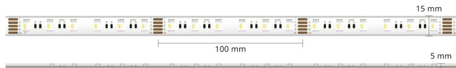
**Ruban LED RGB & Blanc chaud vendu à la coupe.** 19,2 W/m - 60 LED/m - 24V - IP68 (extérieur et immersion dans l'eau) - LED5050.
