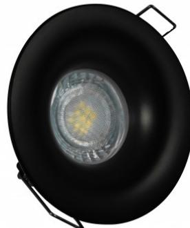
**Spot encastrable rond CURVE** - Dimensions : 85 x 32 mm - Diamètre d'encastrement : 68mm - IP65 - Pour intégration de sources LED GU10.
