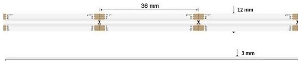
**Ruban LED COB RGB+CCT de 21W/m, vendu au mètre.** 840 LED/m - 24V - IP20 : intérieur uniquement.
