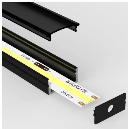
**Profilé noir en applique pour ruban LED.** Ce profilé en aluminium, est également disponible en blanc et en finition aluminium. Dimensions : 18mm x 9,6 mm, compatible avec rubans LED jusqu'à 16mm de large.
