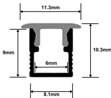
Conçu en aluminium anodisé, il offre une excellente **résistance à la corrosion** tout en assurant une finition moderne et soignée.
