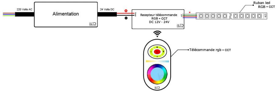
Découvrez d'autres schémas & [aides au branchement des rubans LED en cliquant ici.](#)
