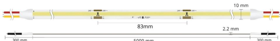
**Ruban LED digital "COB" vendu à la coupe.** 12Watts/m - 24 Volts - 360 LED/m - 36 pixels par mètre - IP20 (en intérieur uniquement).
