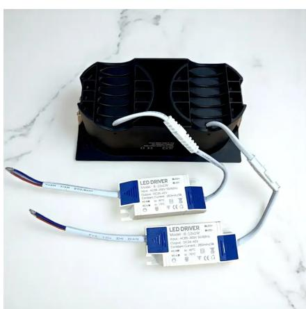
Le **spot LED encastrable Miror** fonctionne en **Très Basse Tension de Sécurité (TBTS)** via un **driver en classe III**, alimenté en **39 V DC**. Son **indice de protection IP44** garantit une protection contre les projections d'eau, ce qui permet son installation en toute sécurité dans le **volume 2 des salles de bains**, conformément à la norme **NFC 15-100**.
