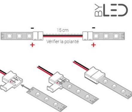
Ce **connecteur** permet de faire une jonction flexible entre **2 rubans LED Blanc chaud / Blanc froid**.
