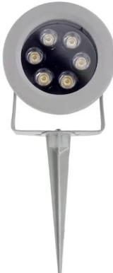
**Spot LED extérieur sur piquet 6W.** En aluminium, laqué gris. Étanche IP65 - Rayon lumineux de 30° - Alimentation : 230V direct (vendu avec 1,5 m de câble)
