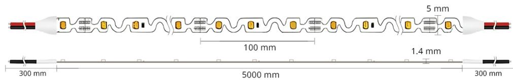
**Ruban LED , rouleau de 5m.** Blanc disponible en 3 températures de couleur. Installation en intérieur IP20 – LED 2835 – 8,6 W/m sous 24V (alimentation non fournie).
