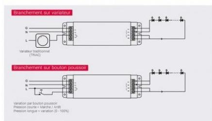
Ce transformateur pour ruban LED est adaptée pour les **rubans LED monochrome** (elle ne peut pas piloter les rubans LED RGB) pour un usage en intérieur uniquement.
