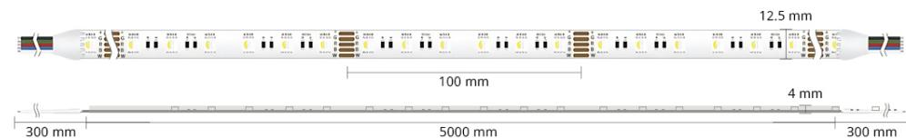
**Ruban LED RGB + Blanc chaud, rouleau de 5 mètres.** Puissant et multicolore. Indice de protection IP65 – LED Epistar 5050 – 19,2 W/m avec 60 LED/m sous 24 volts.
