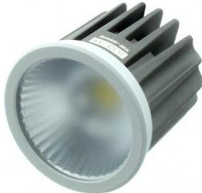
**Source lumineuse LED 3W pour spot.** Conçue pour optimiser sa durée de vie. Diamètre x Profondeur : 47 x 54 mm - Collerette 50 mm - Réflecteur MR16 - Angle de diffusion : 35° - IP64.
