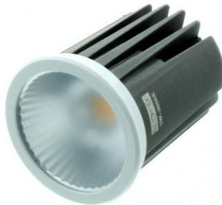
**Ampoule LED 5 W pour spot.** Conception optimale pour la durée de vie de la lampe. Diamètre x Profondeur : 47 x 67 mm - Collerette 50 mm - Réflecteur MR16 - Angle de diffusion : 40° - IP64.
