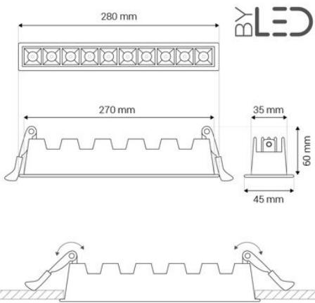
**Barre lumineuse LED 10 x 2 watts.** Cache noir brillant.
